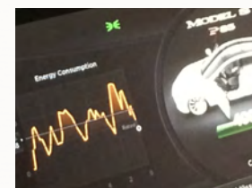
Durch die Motorbremswirkung wird der Akku geladen
