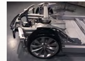
Der Aluminium-Rahmen ist korrosionsarm
