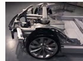
Der Aluminium-Rahmen ist korrosionsarm
